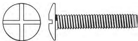
Double fente à utiliser avec un tournevis ou un embout plat.
