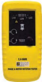
Permet d'identifier l'ordre des phases d'une installation électrique et le sens de rotation d'un moteur avec ou sans contact.
