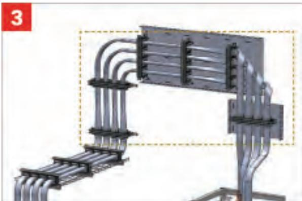
3 Installer les conducteurs dans la partie inférieure du support et monter la partie supérieure du support. Laisser la surlongueur du conducteur au-dessus du transformateur ou de la source de courant.
